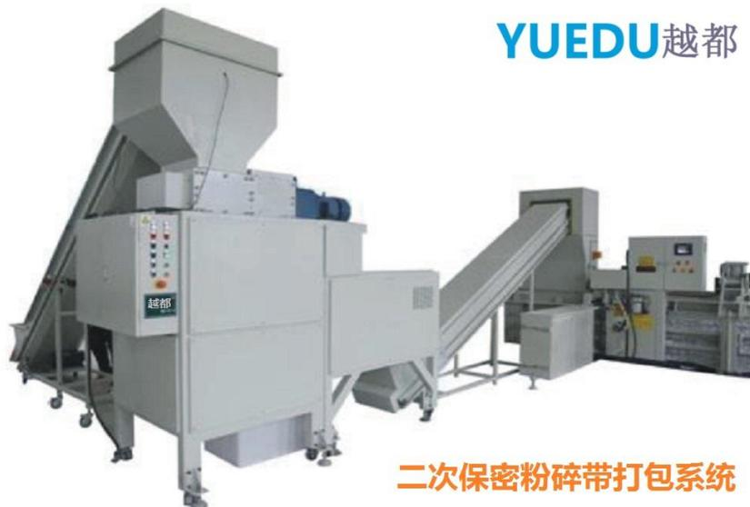
入料设计第一部分——输送带式进料（废料直接输送至碎纸机部分）
